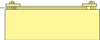
※従来TiN S/Dを使用していたが、バリの発生が多く穴周りの歪みが発生し仕上げ処理に手間取っていたが、ZH342-ViOの使用により突き抜け時の歪みは皆無となり、バリの発生も格段に少なく仕上げ時間が大幅に短縮された。
