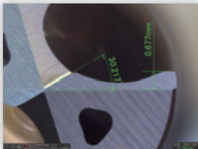
正面から先端部の測定 From the front
