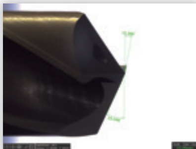
斜め方向からの逃げ角測定 From direction of the point angle
